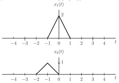
$$x(t) = x_1(t) + x_2(t) \text{ , and let } x_1(t) \stackrel{\mathcal{F}}{\longleftrightarrow} b_k \text{ and } x_2(t) \stackrel{\mathcal{F}}{\longleftrightarrow} c_k$$
