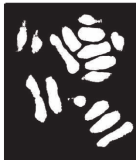
(۶) تصویر اصلی پس از آستانه‌گیری با روش اوتسو با استفاده از هیستوگرام (۵) آستانه‌ی قدر مطلق لاپلاسین: 55
