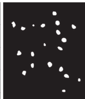
(۶) تصویر اصلی پس از آستانه‌گیری با روش اوتسو با استفاده از هیستوگرام (۵) آستانه‌ی قدر مطلق لاپلاسین: 115
